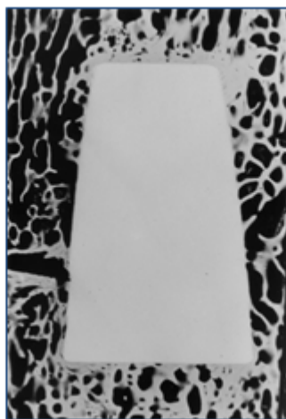
図3. 羊の海綿骨と結合した結晶化ガラス A-W の人工椎体 [5]。
