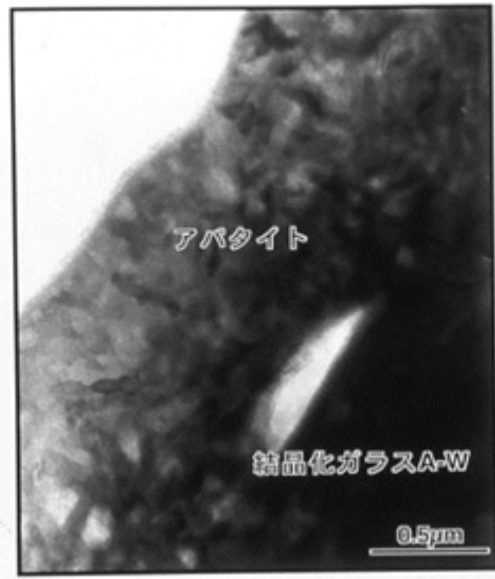
図2. 擬似体液中で結晶化ガラス A-W 表面に生成したアパタイト層の透過電子顕微鏡写真 [4]。
