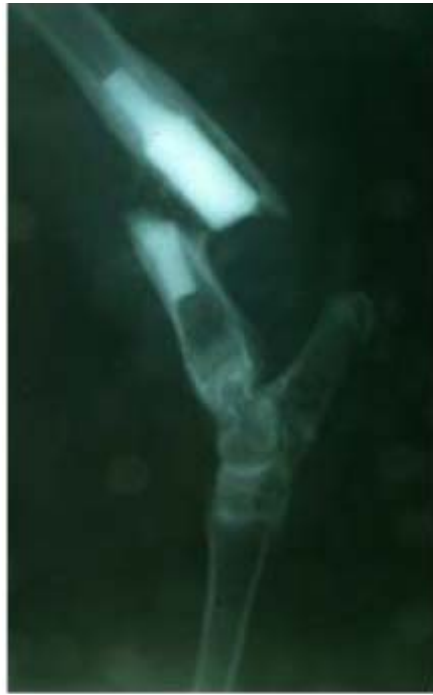
図1 羊の大腿骨に埋入し、6ヶ月後に折れた結晶化ガラス A-W
